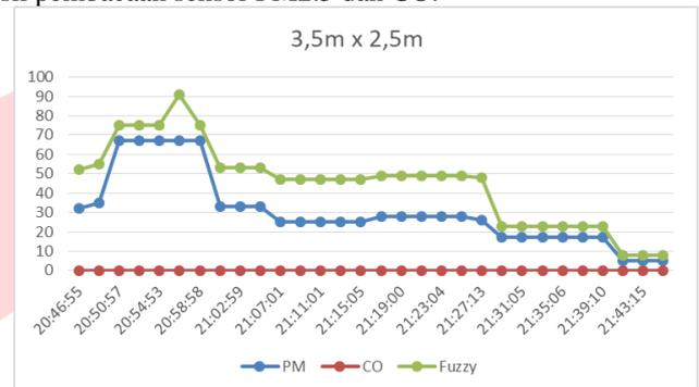
Gambar 13. Pengujian Purifikasi 3.5m x 2.5m
