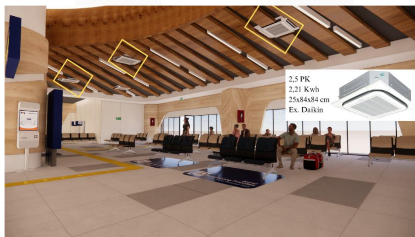
Gambar 7 Implementasi ventilasi mekanis pada ruang tunggu sumber: dokumentasi penulis (2024)
