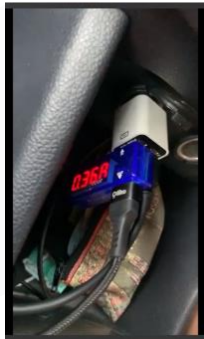
GAMBAR 12 Bukti Pengujian Konsumsi Daya Kondisi Berjalan (2)
