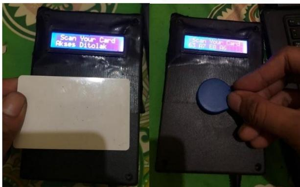
Gambar 4. 1 Pengujian menggunakan e-ktip dan tag biru rfid
