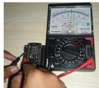
Gambar 15 Pengujian ground dan vcc pada board expansion esp8266
