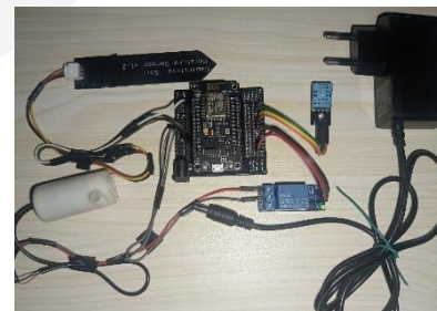
Gambar 11 Implementasi seluruh sistem dengan ESP8266
