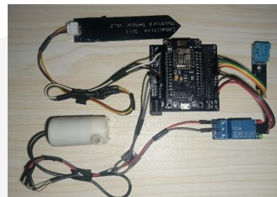
Gambar 10 Implementasi rangkaian ESP8266 dengan komponen
