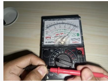
Gambar 14 Pengujian output tegangan adaptor
