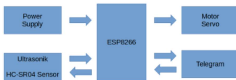
Gambar 1. 3 Mekanisme alat yang memberikan informasi tingkat air waduk
