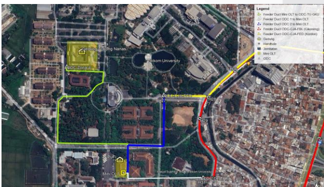
Gambar 3. Pemetaan Lokasi Feeder Telkom University
