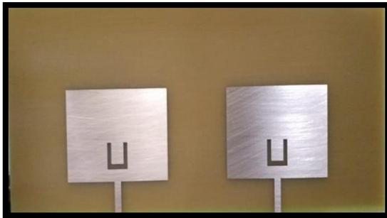
Gambar 8. Tampak Depan Antena Mikrostrip MIMO 2X2 dengan U-Slot dan DGS
