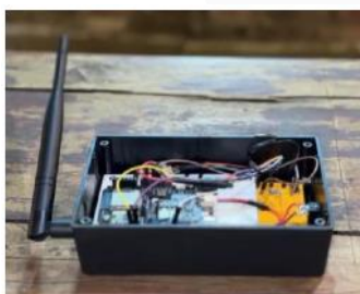
GAMBAR 3.2 Tampilan Luar Hardware GPS Tracker
