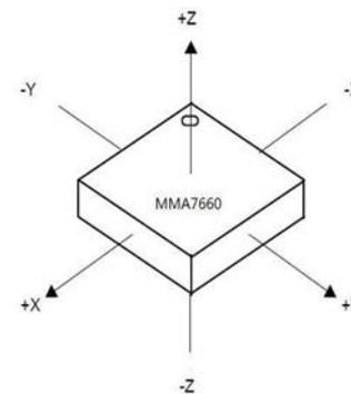
GAMBAR 2 Sumbu Akselerometer
