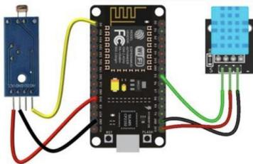
Gambar 3. MH Photoresistor Light Sensor Module yang terhubung dengan DHT11 Sensor dan NodeMCU ESP8266
