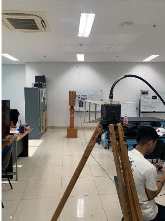
Lampiran 5: Pengujian Menggunakan Antena Horn
