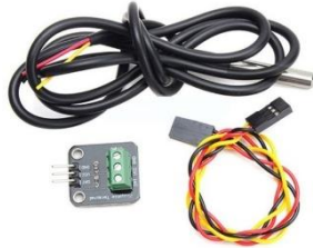
Gambar 2.4 Sensor suhu ( DS18B20)
