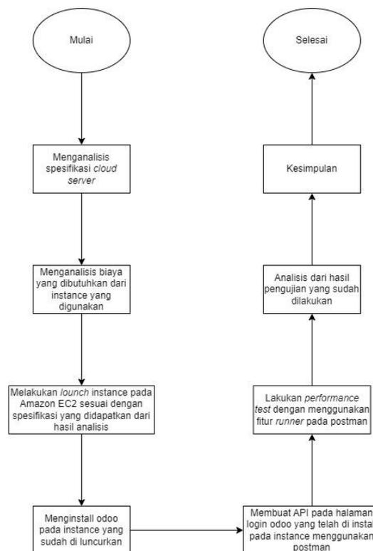
Gambar IV. 10 Skenario Pengujian *Load* Aplikasi Berbasis Web
