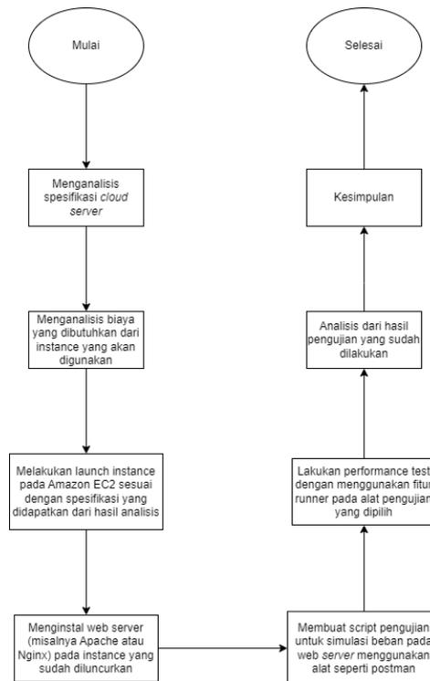
Gambar IV. 9 Skenario Pengujian *Load Web Server*
