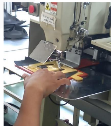
Gambar 3 Proses Pemasangan Mold
