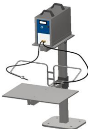
Gambar 8 Bracket Pengunci Mesin Brazing
