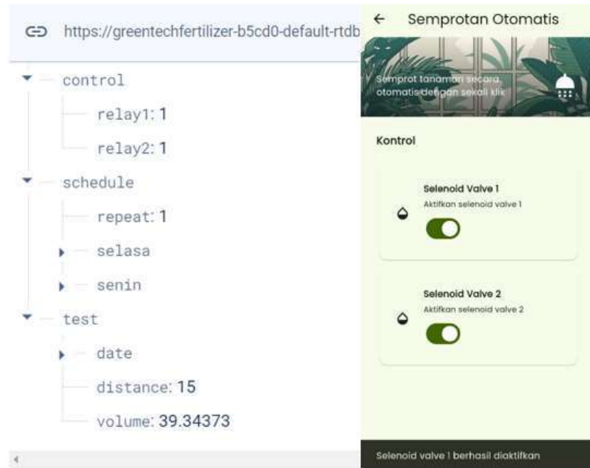
Gambar 4. 4 Pengujian aplikasi semprotan otomatis dengan realtime database
