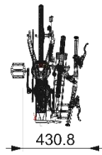
Gambar 14 .Gambar teknik sepeda saat dilipat tampak atas
