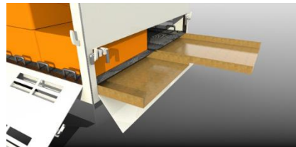
Gambar 3 Mekanisme pintu belakang boks
