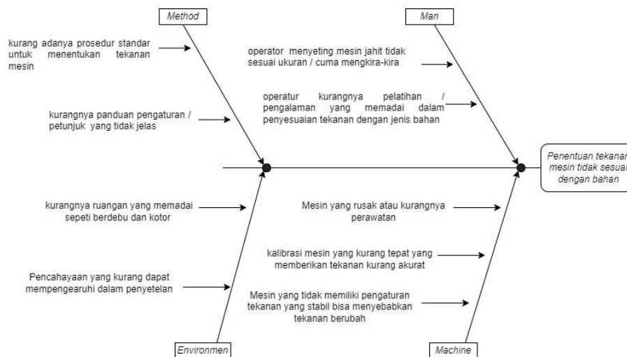
Gambar I.4 Fishbone diagram penentuan tekanan mesin tidak sesuai dengan bahan
