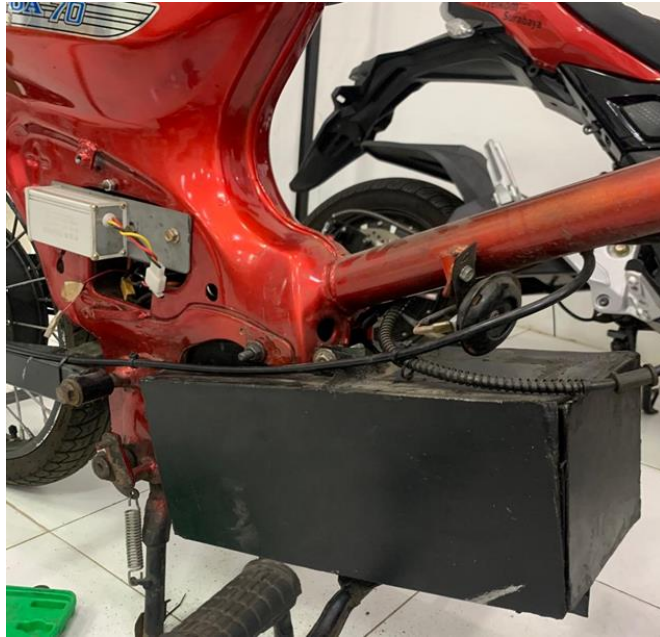
Gambar 1. 2 Case Baterai Existing Motor Listrik C70
