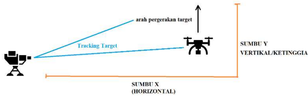
Gambar III.8. Pengujian Tracking secara Vertikal
