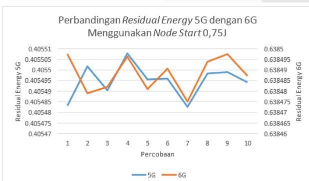
Dari gambar diatas merupakan grafik perbandingan untuk simulasi yang dilakukan pada 20 device yang dimana sudah dimasukkan dengan kondisi dimana nilai dari kapasitas baterai sudah disesuaikan sebesar 1J dimana akan dilakukan percobaan yang akan dilakukan menggunakan *node start* 0,75J dimana transmisi jaringan 5G yang akan diefisienkan dayanya pada saat menggunakan jaringan 6G jadi akan mengetahui dimana yang paling efisien ketika
