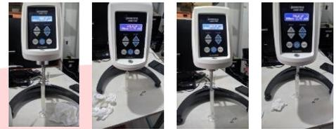
Gambar 4 Pengujian dengan *viscometer Brookfield*
