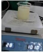
Gambar 1 Proses homogenisasi menggunakan *hotplate stirrer*
