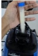
Gambar 2 Proses vortex selama 20 menit setelah dilakukan *stirrer*
