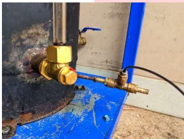
Gambar 4. 15 Letak sensor MAX6675
