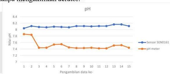
Gambar 16. Hasil pengukuran pH tanpa menggunakan aerator.
