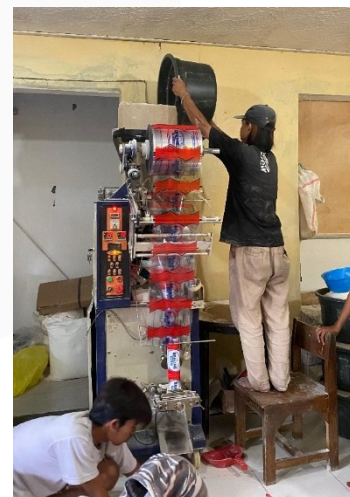
GAMBAR 1 PROSES MEMASUKKAN TEPUNG KE MESIN
