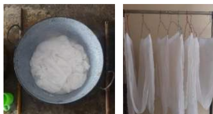
Gambar 1 Proses scouring kain (Sumber: Dokumentasi pribadi, 2025)
