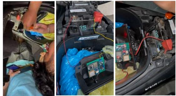
GAMBAR 5 Proses Instalasi Perangkat IoT
