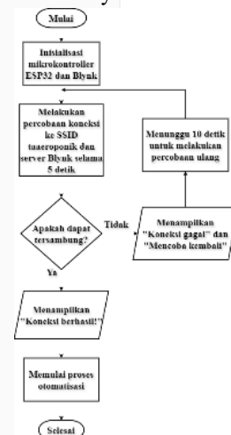
GAMBAR 4 (Diagram alir proses koneksi sistem ke Blynk)
