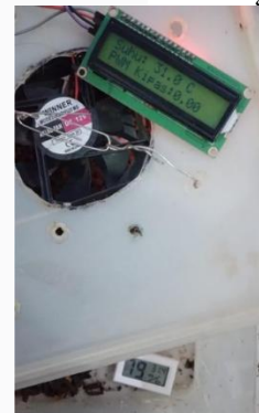
GAMBAR 19 (Kalibrasi Sensor Suhu DHT 22 dengan Hygrometer)
