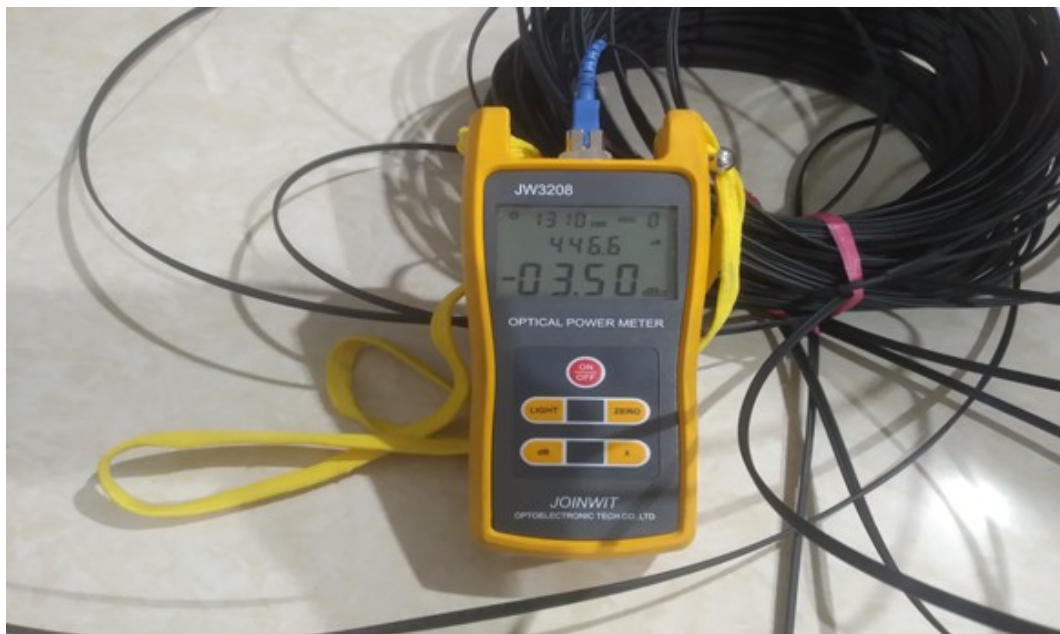
Gambar 5.8 Hasil pengujian output HTB A pada rumah kedua.
