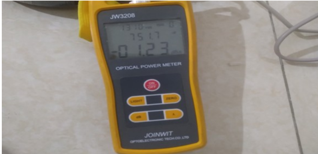
Gambar 5.7 Hasil pengujian output HTB A pada rumah pertama.
