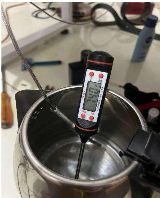
Gambar 4. 1 kalibrasi thermocouple menggunakan thermometer
