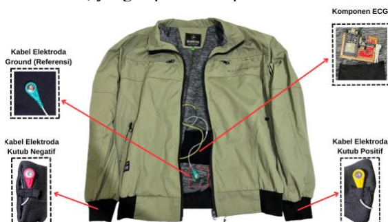
Gambar 3 (Perangkat Wearable ECG berbasis Jaket)
