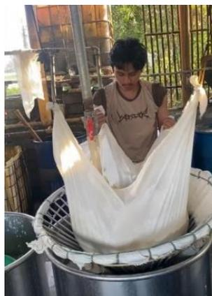
Gambar I-3. Proses Penyaringan Bubur Kedelai Manual
