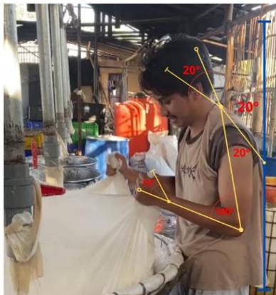
Gambar I-4. Proses Penyaringan Bubur Kedelai Dengan Perhitungan RULA
