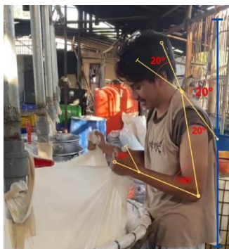
GAMBAR 6 PENGUKURAN EKSISTING SUDUT PADA OPERATOR
