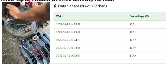
GAMBAR 6. Perbandingan Keluaran Data Tegangan dengan Multimeter
