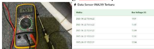
GAMBAR 4. Perbandingan Sensor dengan Multimeter
