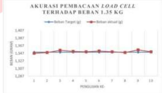
Gambar 15 Grafik Akurasi Pembacaan Load Cell Beban 1.35 kg.
