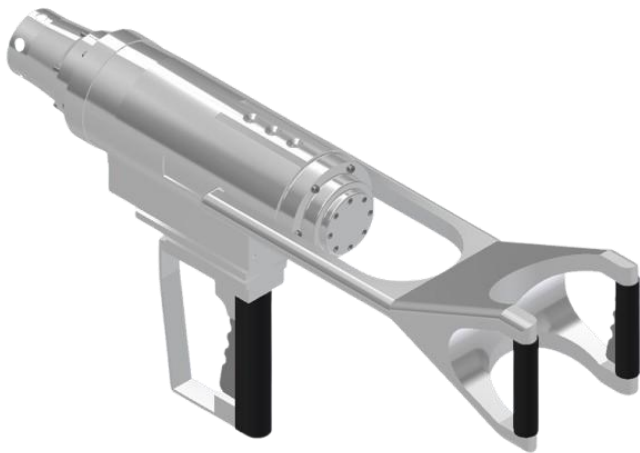
GAMBAR 11. Hasil Rancangan Alat Pneumatic Stunner
