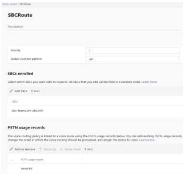
Gambar 7. Konfigurasi voice routes untuk mengarahkan panggilan ke SBC
