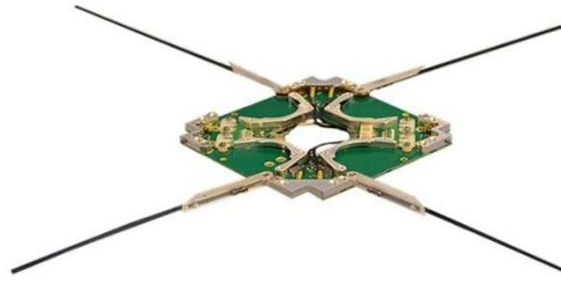
**Gambar 1. 2** Antena Deployable Untuk CubeSat
