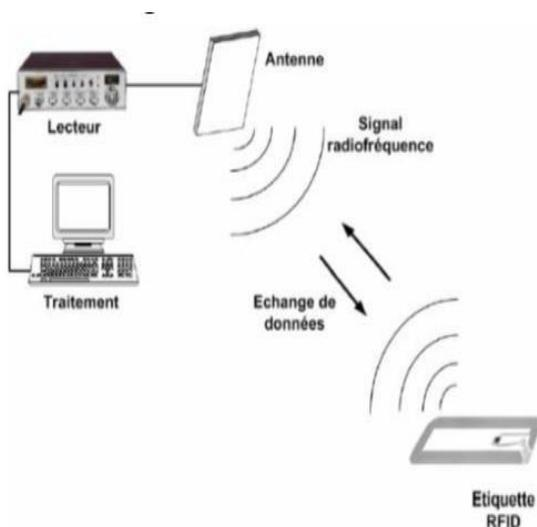
Gambar 1 Sistem Kerja RFID<sup>[4]</sup>
